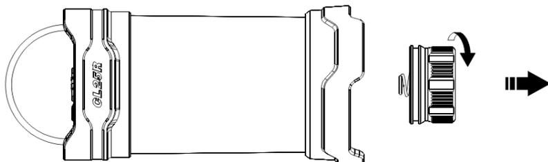
Открутите крышку батарейного отсека против часовой стрелки.
